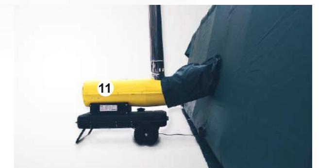
11. Для отопления в зимнее время сооружение оснащено **дизельным вентиляционно-отопительным агрегатом**.
