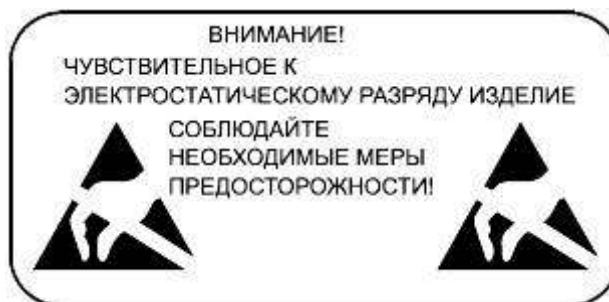
Рисунок А.2 - Маркировка, указывающая на то, что изделие является чувствительным к ЭСР
