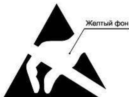
Рисунок 12 - Чувствительная к электростатическому разряду деталь или узел
