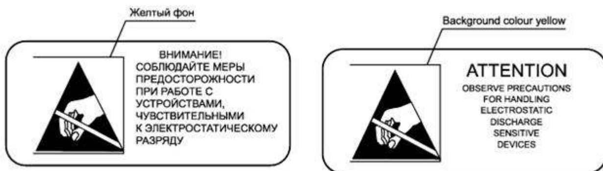
Рисунок 13 - Пример маркировки чувствительных к электростатическому разряду устройств
